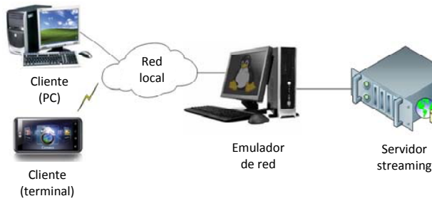
Fig. 2. Componentes de la maqueta de evaluación.
