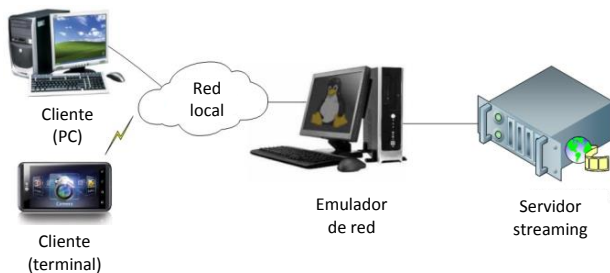
Fig. 2. Componentes de la maqueta de evaluación.
