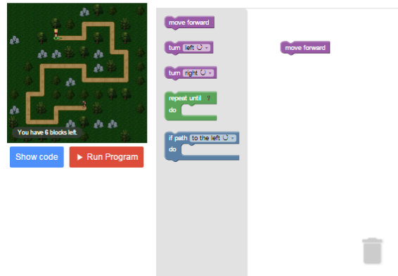
Fig. 3. Ejemplo de ejercicio con Blockly integrado en edX como parte del laboratorio de la semana 1 en el que los alumnos deben llegar al final de un laberinto utilizando bloques que representan movimientos, giros, bifurcaciones y bucles.
