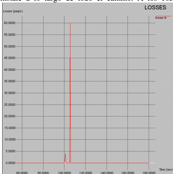
Figura 4: Paquetes de VoIP perdidos por segundo en el caso desacoplado.
