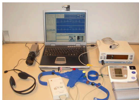
Fig. 1. Aplicación de telemonitorización diseñada para UVI móvil sobre UMTS, que incluye módulos específicos en tiempo real.
