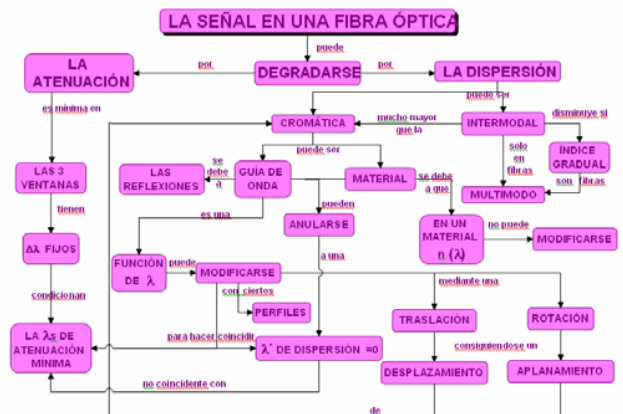
Fig. 8 Mapa conceptual que recoge todos los conceptos y fenómenos relacionados con la transmisión de una señal a través de fibra óptica.
