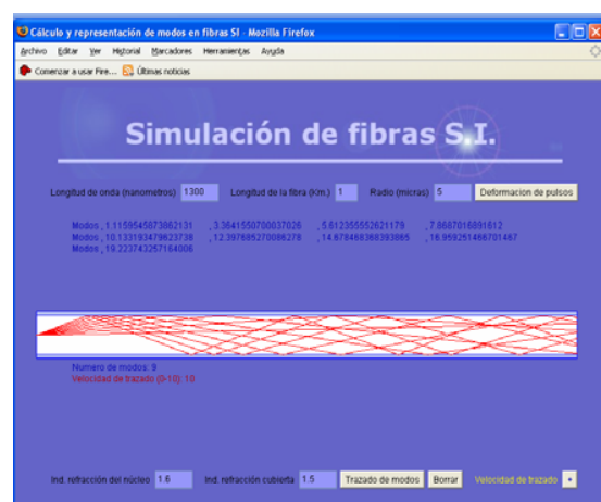
Fig.3 Simulación que calcula y representa los modos de propagación de una fibra óptica dependiendo del radio del núcleo de la fibra, el salto de índice núcleo-revestimiento y la longitud de onda de la radiación empleada.
