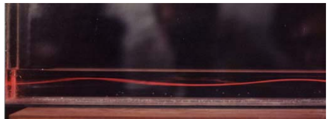
Fig.2 Trayectoria de la luz láser a través de una disolución estratificada que se ha dejado mezclar en las interfases
