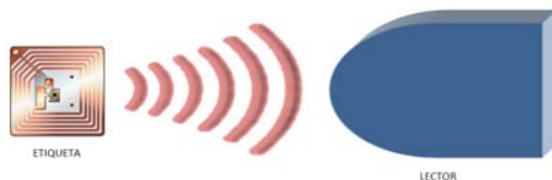
Fig. 1. Esquema básico de un sistema RFID.
