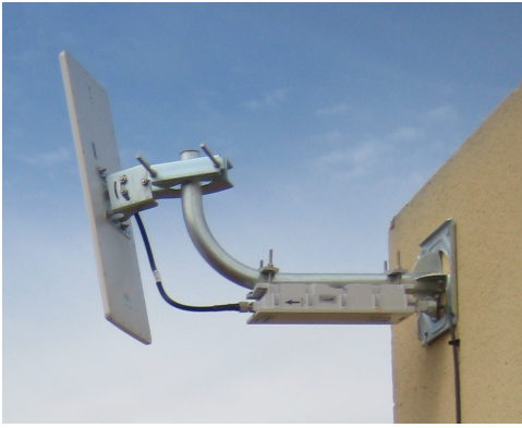
Fig. 2. Estación base real basado en WiMAX.
