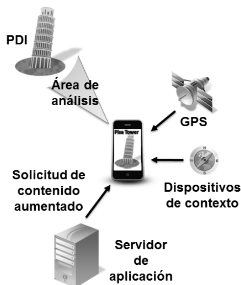
Fig. 2. Arquitectura general del nivel de colaboración aislado.
