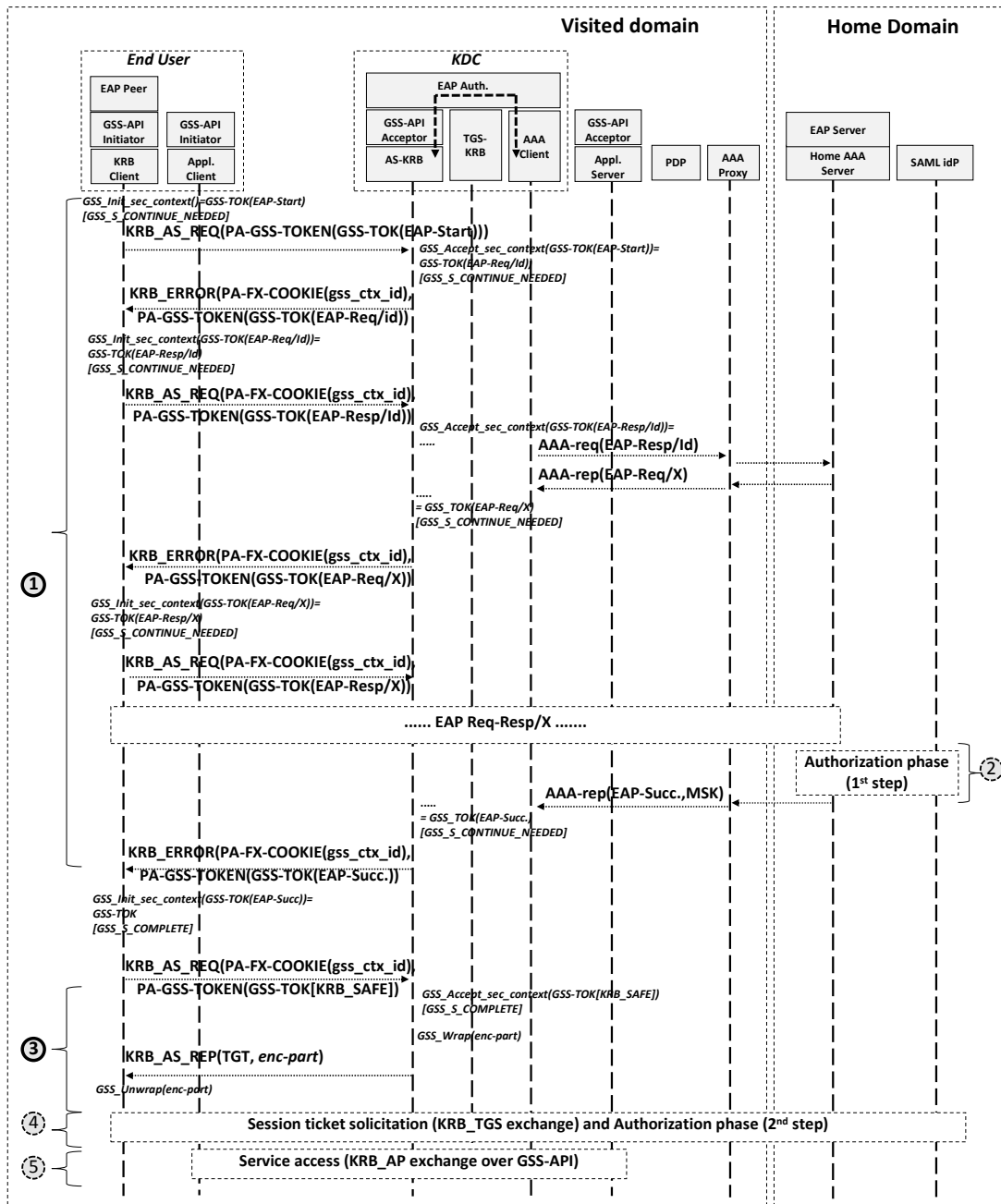
Fig. 3. Pre-autenticación basada en EAP sobre GSS-API sobre Kerberos
