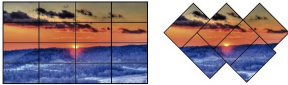
Fig. 1. Videowall uniforme plano (izquierda) y disforme (derecha)
