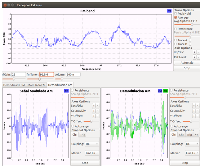
Fig. 8. Resultado de la ejecución del diagrama de bloques del receptor estereofónico de FM.
