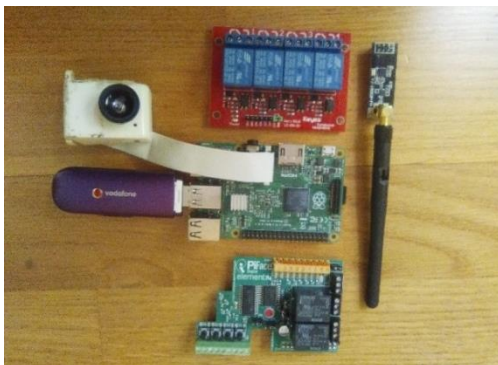
Fig. 5. Nodo central con actuadores, conectividad radio y 3G.
