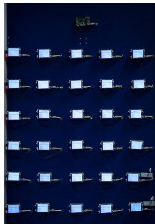
Figura 3: Imagen de la plataforma desplegada. Transmisor en la parte superior y 30 receptores en la matriz de 6x5
