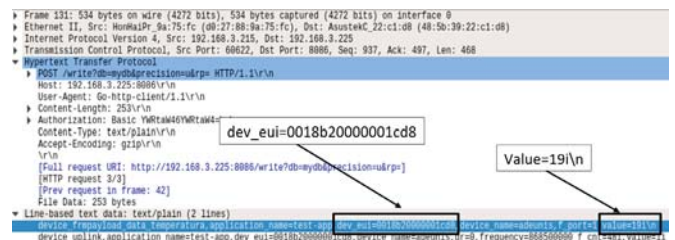
Fig. 4. Paquete interceptado mediante técnicas de sniffing utilizando la herramienta Wireshark entre el servidor de aplicaciones LoRa y la base de datos InfluxDB.
