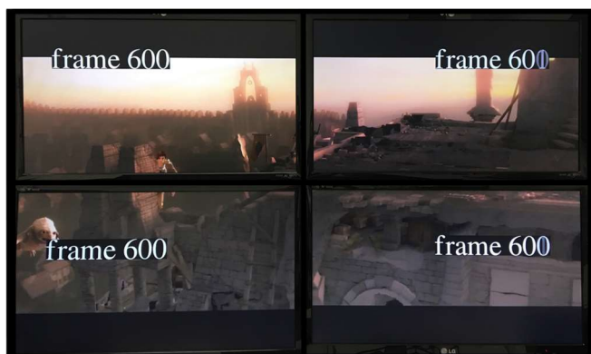
Fig. 7. Detalle del sistema videowall 2x2 reproduciendo el contenido con el número de fotograma insertado.
